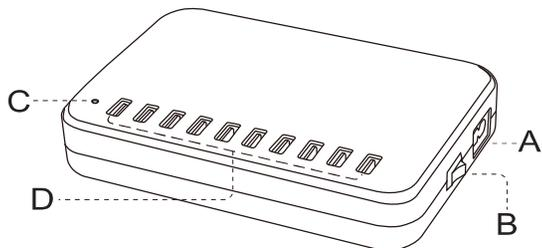
1. Das Netzkabel am Stromanschluss **(A)** einstecken. Anschließend das Netzkabel mit der Stromversorgung verbinden (z. B. Wandsteckdose).
